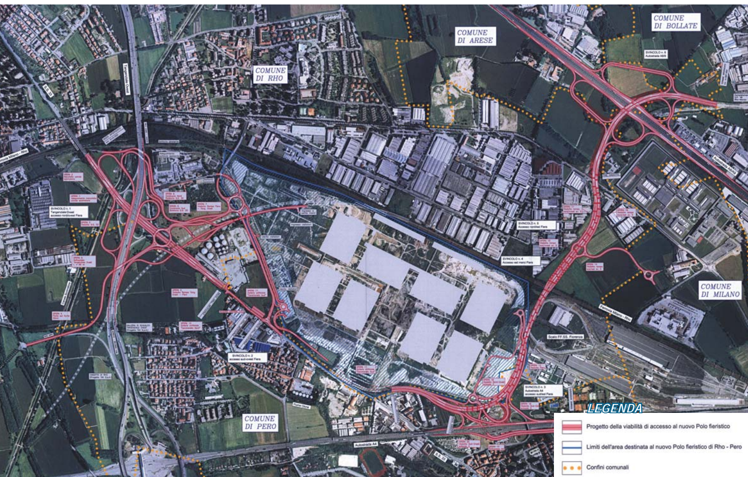
Sopra: Realizzazione della viabilità di accesso al Nuovo Polo Fieristico di Rho-Però
